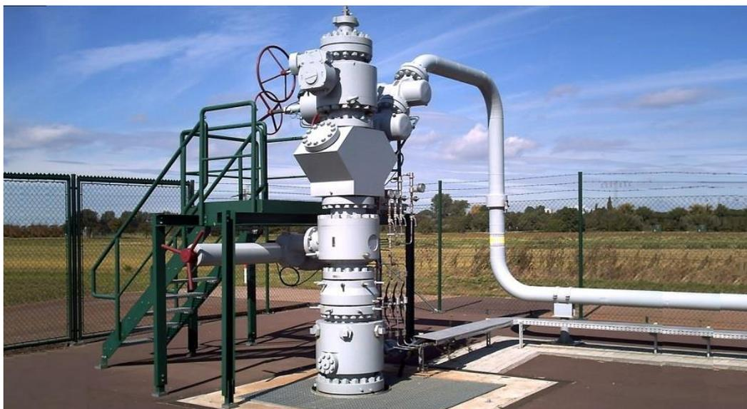
Рисунок 1.2 – Общий вид устья скважины
